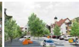
Belagsgestaltung auf dem Marktplatz mit optischer Geschwindigkeitsbremse durch quergerichtetes Muster. | Q: Fotomontage UmbauStadt
